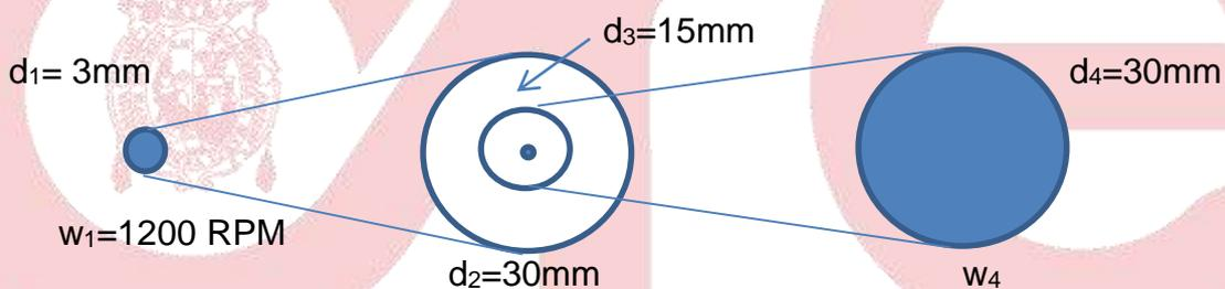
Del eje del motor (tomemos como primera polea) y la segunda polea, tenemos:
