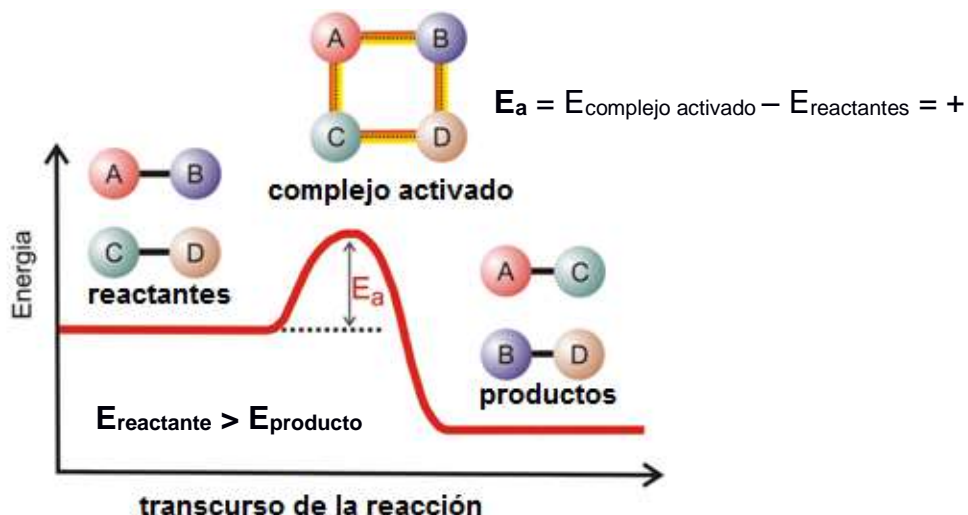
Figura 2: Curso de una reacción sencilla exotérmica donde E_{RX} = E_{\text{productos}} - E_{\text{reactantes}} = -
